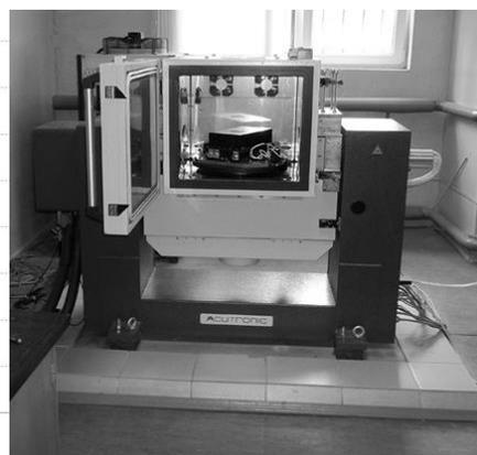
Рис. 11. Испытания БИНС-500М на двухосном поворотном стенде
