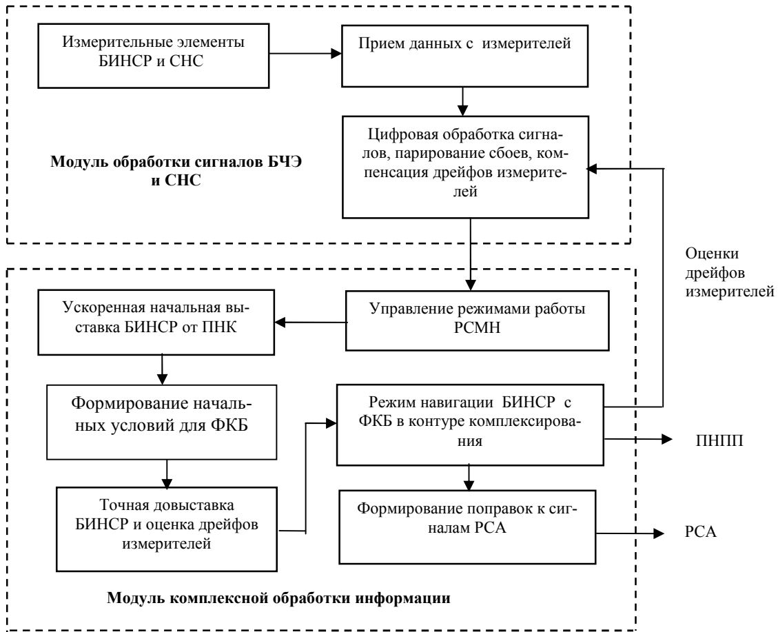
Рис. 3. Структурная схема программно-математического обеспечения РСМН
