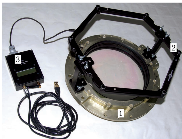
Рис. 3. Платформа приемников на иллюминаторе и блок управления: 1 – иллюминатор; 2 – платформа приемников; 3 – блок управления и индикации
