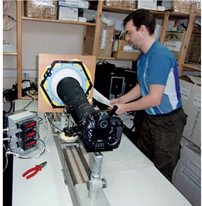
Рис. 7. Испытания системы координатной привязки фотоизображений на стенде измерения угловых и линейных параметров
