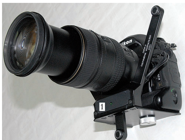
Рис. 4. Платформа излучателей на фотоаппарате (1)
