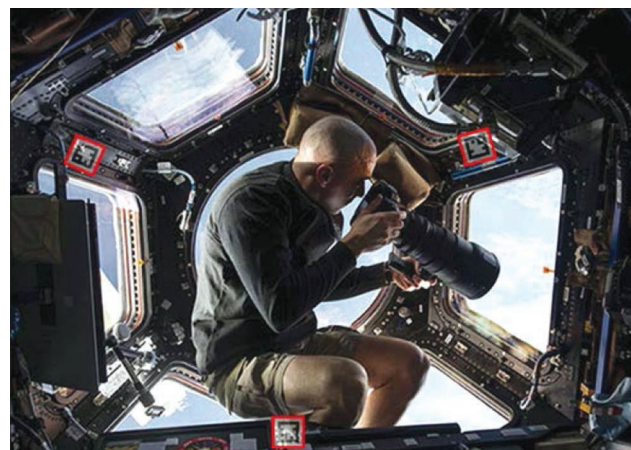
Рис. 1. Вариант угломерной системы NASA (маркеры отмечены красным) для съемок из модуля Cupola
