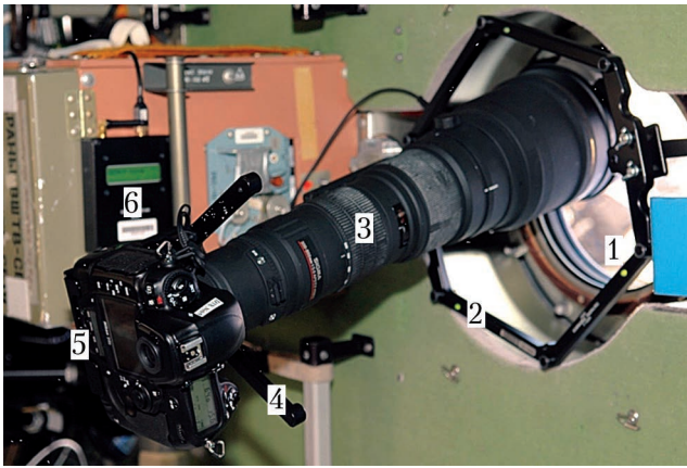
Рис. 8. Система координатной привязки фотоизображений в сборке на иллюминаторе № 6 служебного модуля МКС: 1 – иллюминатор; 2 – платформа приемников; 3 – длиннофокусный объектив; 4 – платформа излучателей; 5 – фотоаппарат; 6 – блок управления
