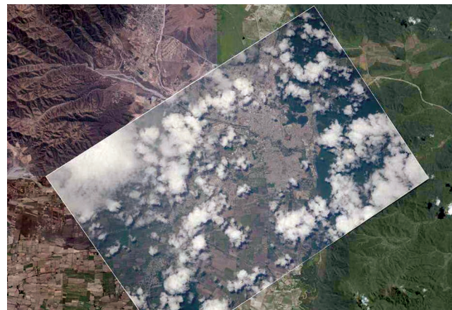
Рис. 11. Изображение г. Сальта (Аргентина), опознанное и наложенное на ортофотоплан. Съемка 21 января 2015 г. с борта МКС. Фотоаппарат Nikon D4. Фокус 700 мм. Дальность 420 км. Масштаб исходного изображения 4,6 м/пиксель. Расчет координат с помощью системы координатной привязки фотоизображений позволил уверенно опознать местность, несмотря на наличие облачности
